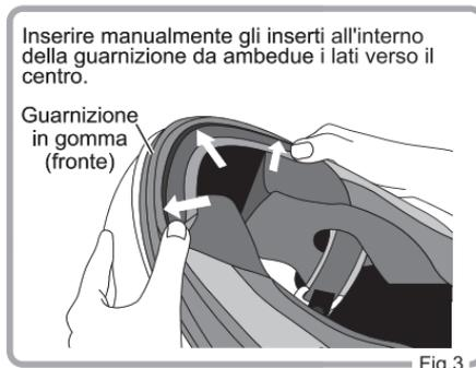
4. Posizionare gli inserti in modo tale che il bordo della guarnizione in gomma sia quasi a filo con Wind Shutter-2.
